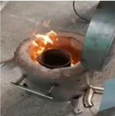
Figura 3. Primer prototipo de fragua (Flauta en forma de Y corta)
