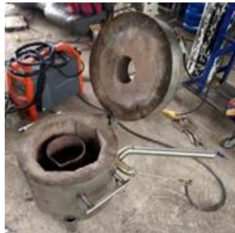
Figura 4. Segundo prototipo de fragua (Flauta en forma de Y completa)
