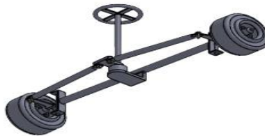
Figura 7: Imagen de solidworks de la dirección del Go-Kart
