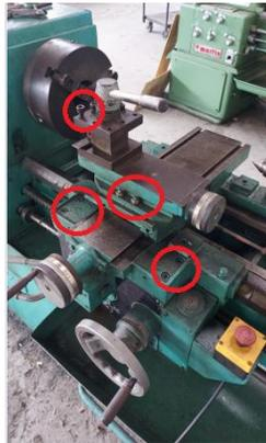
Figura 4. Puntos donde se sitúan algunos elementos que presentan falta de ajuste o fuga de presión.
