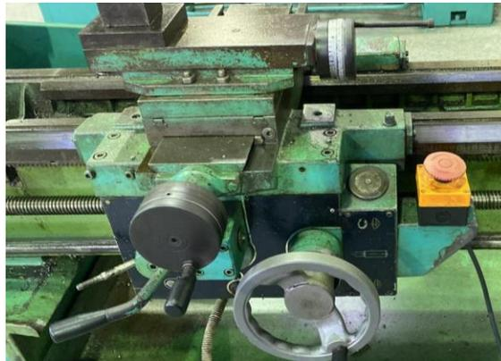
Figura 3. Se presenció ruidos y vibraciones en los manubrios del torno Pinacho L1-125
