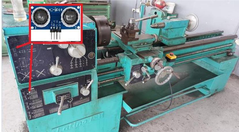
Figura 7. Ubicación de Sensor Ultrasónico HC-sr04 en el cabezal fijo.
