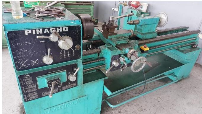
Figura 6. Imagen del Torno Pinacho L1-125, donde se aprecia el estado del carro longitudinal
