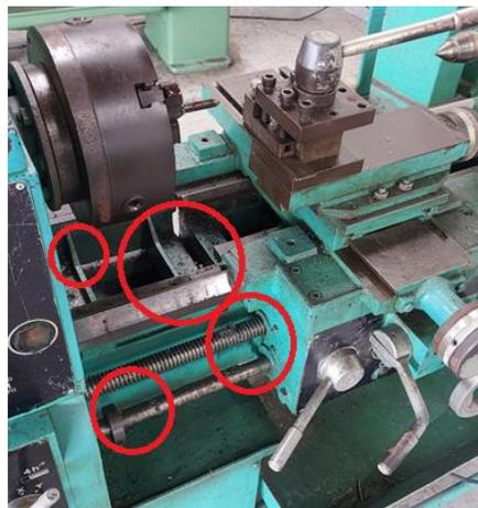
Figura 1. Falta de lubricación los componentes móviles del torno Pinacho L1-125
