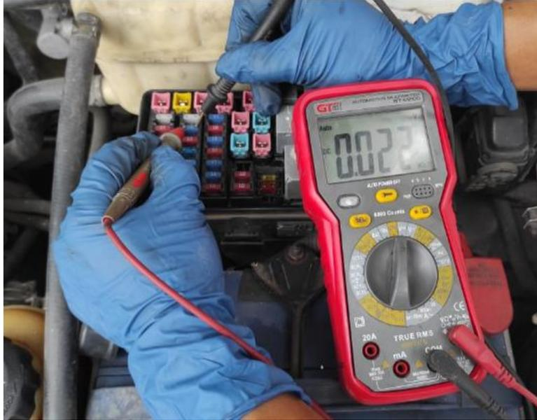
Figura 8. Medición de caída de voltaje. Fuente: Autor, 2024
