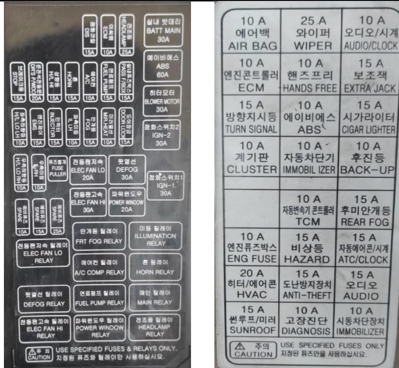
Figura 7. Valores de fusibles según el fabricante Fuente: (Autor, 2024)
