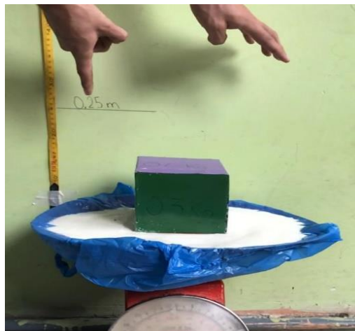
Figura 5. Demostración de Cubo de 0.3 kg impactando el fluido no newtoniano (Oobleck)
