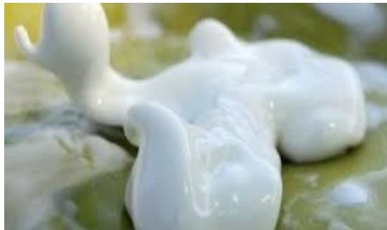
Figura 2. Demostración de viscosidad dependiente del esfuerzo
