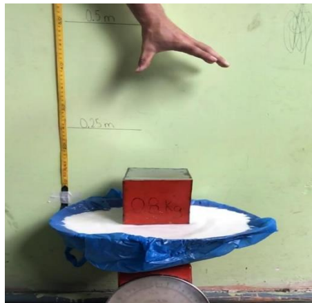
Figura 7. Demostración de Cubo de 0.8 kg impactando el fluido no newtoniano (Oobleck)
