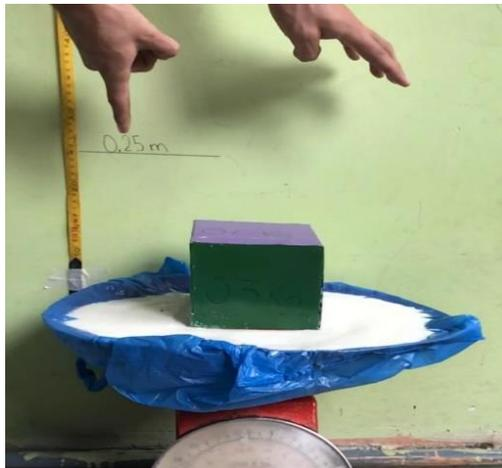
**Figura 6.** Demostración de Cubo de 0.6 kg impactando el fluido no newtoniano (Oobleck)
